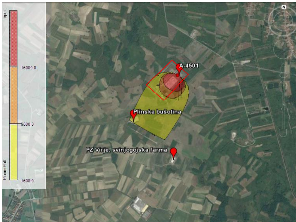
Slika 33. Disperzija oblaka eksplozivnih para nakon 5 minuta
